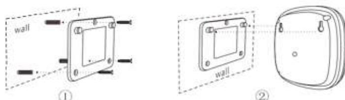
Na upevnenie montážnej konzoly použite skrutky.
